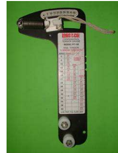
Foto 23 - Tensiometro Loose&Co Mod PT-1
