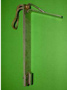
Foto 22 - Tensiometro Loose&Co 91-Mod.A
